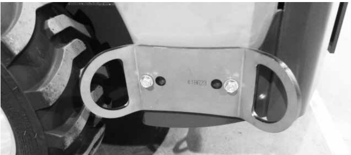
Sidontakiinnike A418623 asennettuna takarungon sivuun. Sivuasuunnuksessa tarvitaan kaksi sidontakiinnikettä.
